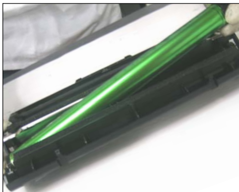
10. Sacar el cilindro cuidando de no golpear o arañar el mismo contra la cuchilla de dosificación.
