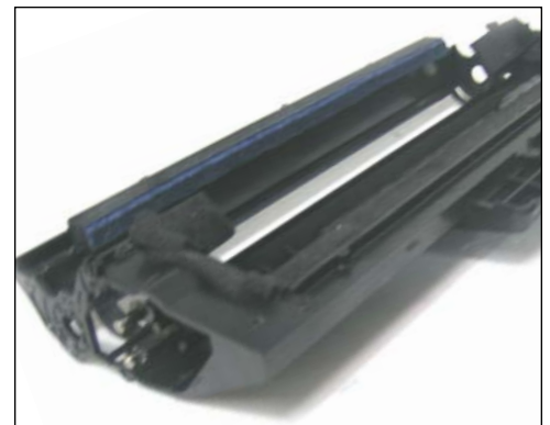
21. El cartucho puede ahora ser limpiado y armado nuevamente.
