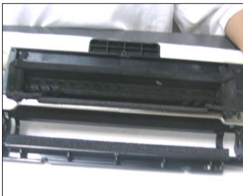
11. Vista frontal del cartucho sin su PCR y cilindro OPC.
