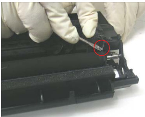
19. Destrobar el segundo clip ubicado en el lado opuesto.
