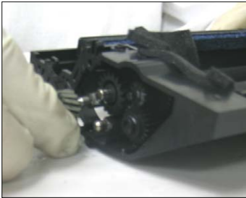
16. Sacar los engranajes como se muestra.
